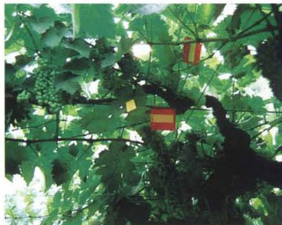
Un problema specifico risolvibile con l'analisi dell'immagine è la valutazione della qualità di distribuzione delle macchine per i trattamenti di colture attraverso l'analisi delle cartine idrosensibili analizzate al microscopio e l'acquisizione dell'immagine dell'area irrorata mediante videocamera.
